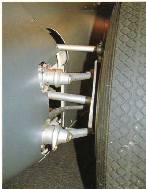
VWにも共通するダブル・トレーリングアームと横置きトーションバーのifs. 4WDなのでハーフシャフトが見える。
